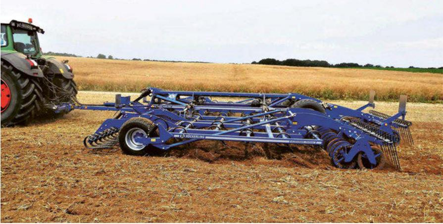
Flache Bodenbearbeitung mittels Grubber
